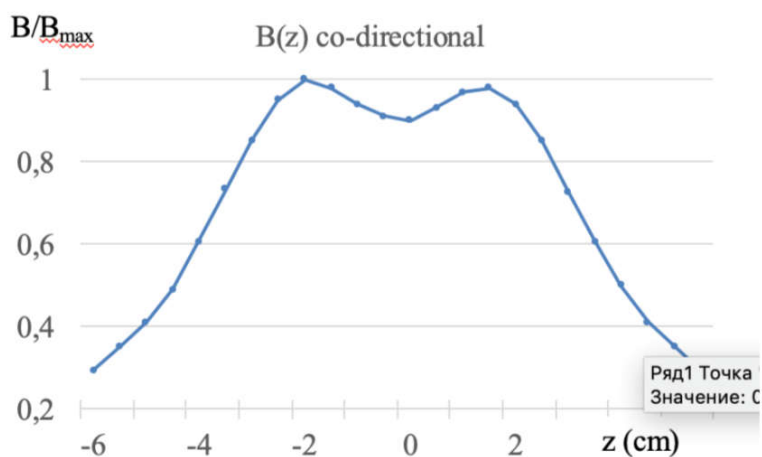
Рис.3.8. Пространственное распределение магнитной индукции на оси магнитной системы.
