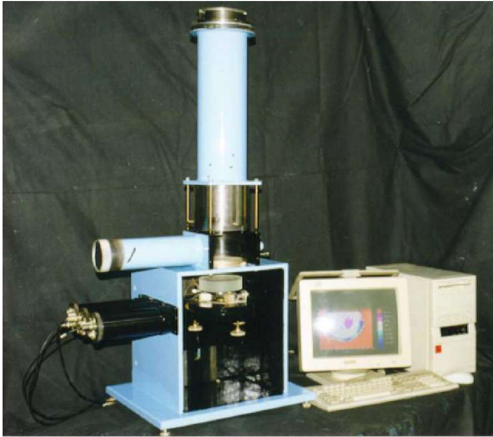
Рис. 36 - Фотография интерферометра для контроля плоских поверхностей диаметром до 100 мм.
